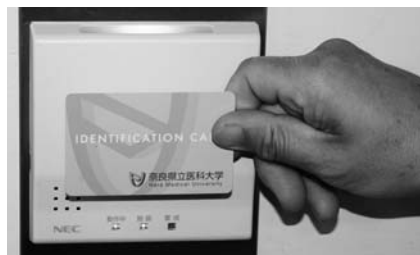
入退室管理システム
